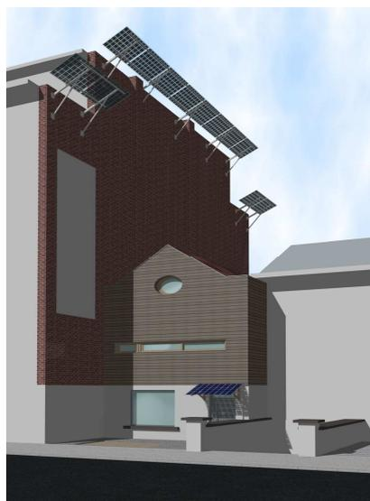
Le projet, abandonné pour des raisons budgétaires, est une étrange petite maison à un seul étage avec une façade en pignon. La maison est orientée Est-ouest. Le gros immeuble à côté bouche entièrement l'orientation Sud. La toiture et la charpente existantes seront démontées et recrées en ossature bois. Cette nouvelle enveloppe sera isolée au standard passif. La nouvelle structure bois sera composée de portiques formés de poutre en I à âme d'OSB recouverts de panneaux
