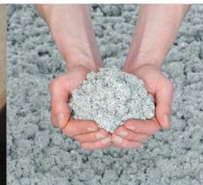
Isolation de la toiture en ouate de cellulose insufflée
